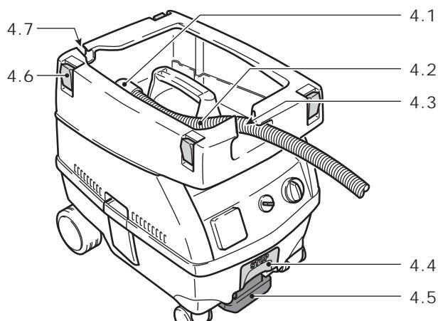
El tubo flexible de aspiración (4.2) se conecta mediante la pieza angular (4.1) al orificio de aspiración. Durante la operación, el tubo flexible de aspiración es insertado en el hueco (4.3).
