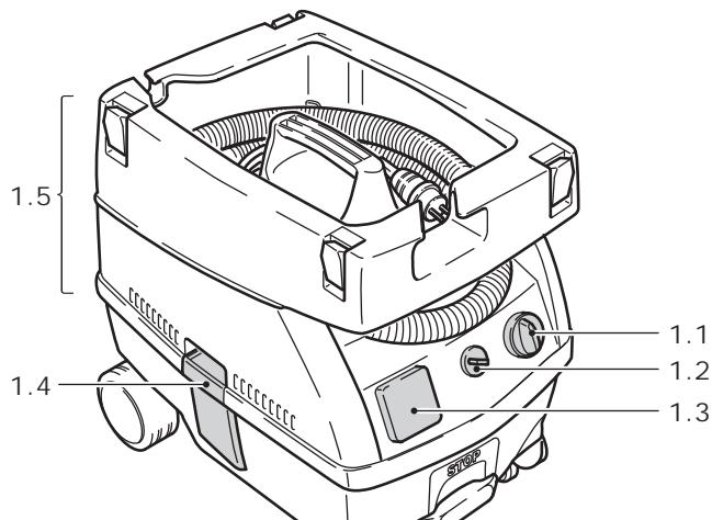
En position **0** (1.1), l'aspirateur est éteint et la prise de l'appareil (1.3) n'est pas sous tension.
